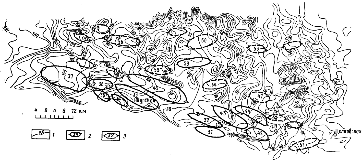
Рис. 2. Карта тектономорфоизогипс Затеречной структурной зоны: 1 — тектономорфоизогипсы; 2—3 — выявленные морфоструктуры: 2 — уверенно (31 — Правобережная, 32 — Левобережная, 33 — Наурская, 34 — Знаменская, 35 — Гвардейская, 36 — Ищерская, 37 — Стодеровская, 42 — Червленная, 43 — Западно-Червленная, 44 — Центральная Червленная, 45 — Северо-Наурская), 3 — требующие детальных морфоструктурных исследований (46 — Западно-Наурская, 47 — Северо-Червленная, 51 — Старощедриновская, 52 — Восточно-Червленная, 53 — Нагайская, 54 — Барханная, 55 — Бурунная, 56 — Северо-Галюгаевская, 59 — Центральная, 60 — Северная)
